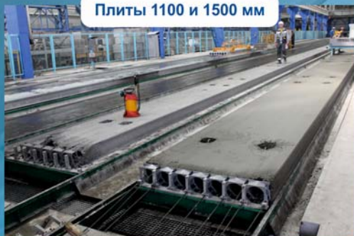
Первые метры формовки бетона
