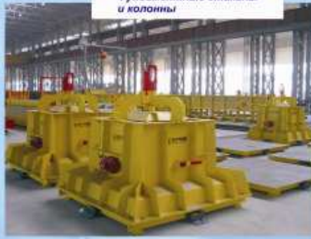
Фундаментные стаканы и колонны
