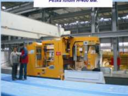
Резка плит H-400 мм.
