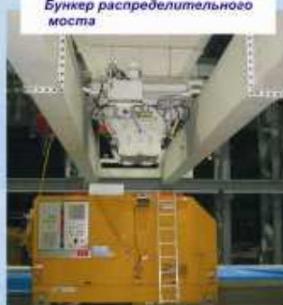
Бункер распределительного моста
